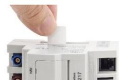
**Vorsicht:** Vergewissern Sie sich beim Einschieben, dass die SIM-Karte wirklich im SIM-Kartenhalter steckt. Zum Entfernen drücken Sie leicht auf die Kante der SIM-Karte. Dadurch wird sie ein Stück herausgeschoben.
