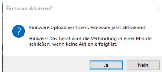
Bestätigen Sie die Schaltfläche Nein, wird der Update-Vorgang abgebrochen. Der Zähler arbeitet weiterhin mit dem alten Firmware-Stand.
