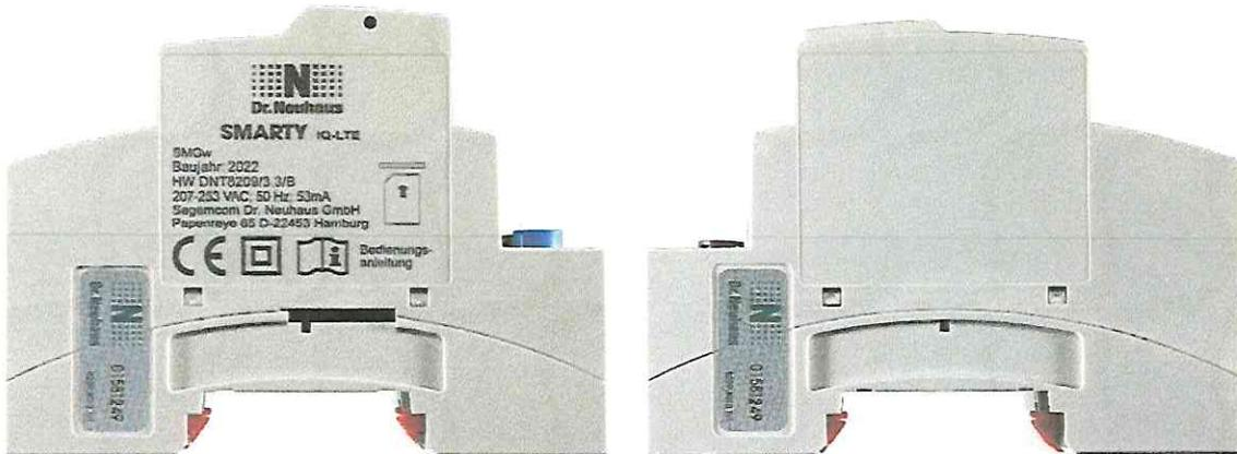
Bild 2 Seitenansichten (Variante 3.3/B) mit Darstellung der Zugriffssicherung des Herstellers (Musterabbildung). Die rechts dargestellte Zugriffssicherung ist für alle Produkte der Variante „B“ gültig.
